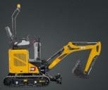
MINIBAGGER 5Y10U Motor KUBOTA D722 Leistung 8,8 kW / 2200 U/min Löffelkapazität 0,025 m³ Betriebsgewicht 1195 kg
